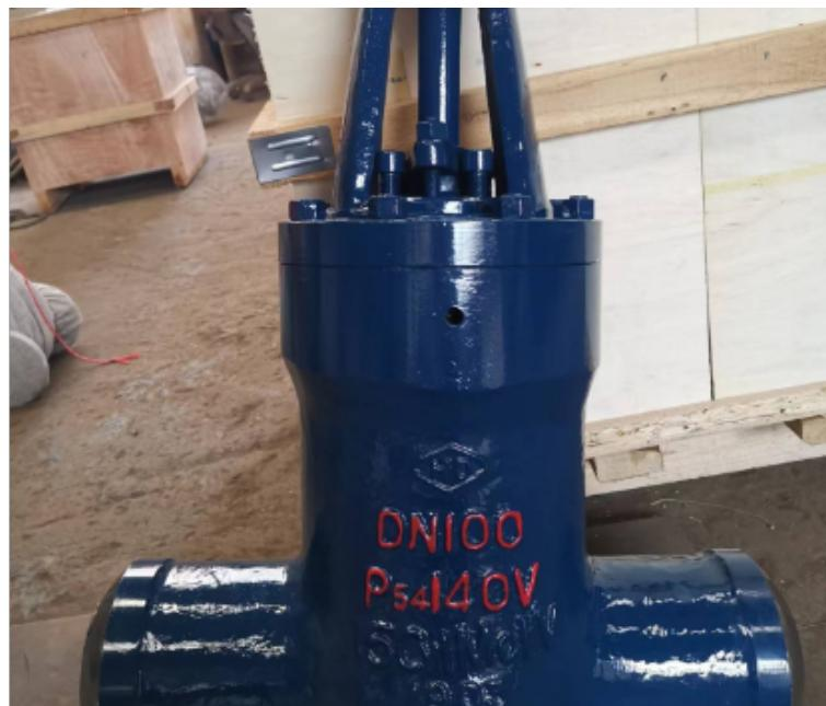
电动闸阀结构特点：阀门采用压力自紧式密封或阀体、阀盖垫片密封结构，值得信赖！使用安全可靠。阀瓣采用双闸板中间带万向顶结构，能自动调整阀瓣与阀座密封面吻合度，保证阀门的密封。同时此结构维修方便，节约费用，阀瓣互换性较好。阀瓣、阀座密封面用钴铬钼硬质合金由等离子喷焊而成，密封面硬度高，耐磨擦，抗擦伤，使用寿命长。阀杆用渗氮钢制成，表面氮化处理，硬度高，抗擦伤，耐腐蚀，使用寿命长。手动阀门由手动机构或撞击时手轮开启。减小阀门操作力。湖北气动闸阀直销闸阀，就选上海精一电站阀门有限公司，用户的信赖之选，欢迎您的来电哦！
