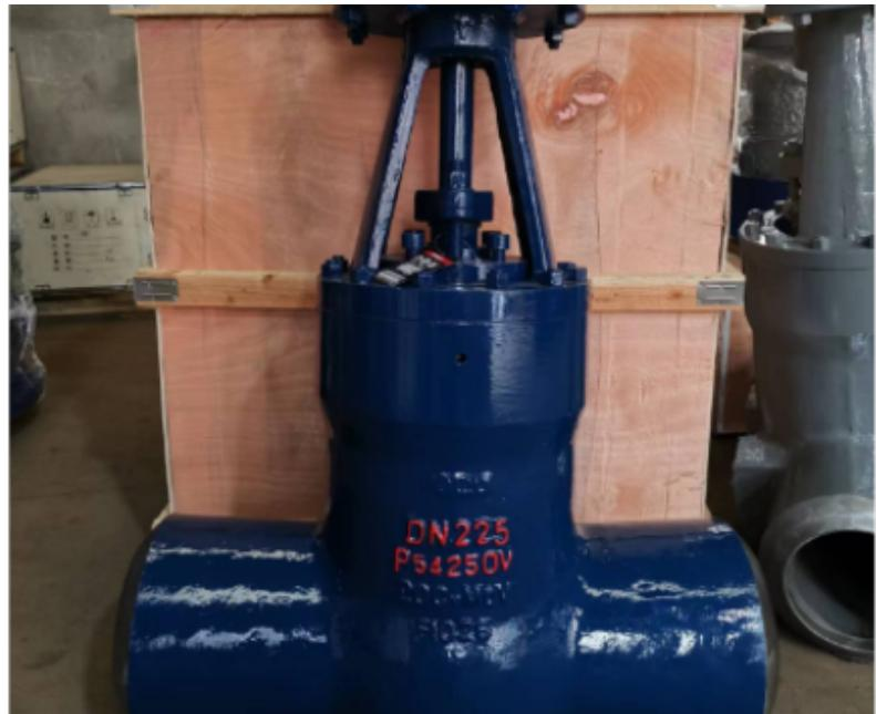
气动阀采购时只明确规格、类别、工压就满足采购要求的作法，在当前市场经济环境里是不完善的。因为气动阀制造厂家为了产品的竞争，各自均在气动阀统一设计的构思下，进行不同的创新，形成了各自的企业标准及产品个性。因此在气动阀采购时较详尽的提出技术要求，与厂家协调取得共识，作为气动阀采购合同的附件是十分必要的。气动闸阀，借助压缩空气驱动的阀门，闸阀关闭时，密封面可以只依靠介质压力来密封，即依靠介质压力将闸板的密封面压向另一侧的阀座来保证密封面的密封，这就是自密封。大部分闸阀是采用强制密封的，即阀门关闭时，要依靠外力强行将闸板压向阀座，以保证密封面的密封性。
